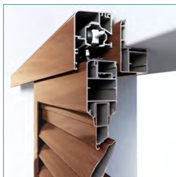
Guida superiore con Mantovana e telaio TL/Imb
