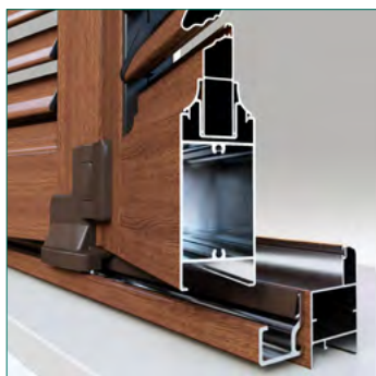
Sezione inferiore anta e telaio
