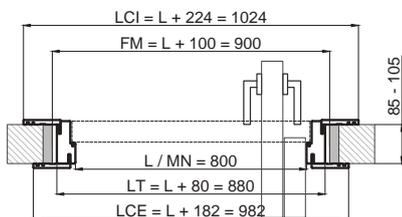
PORTA ROTOTRASLANTE REVERSIBILE TELAIO PKROTO / L8
