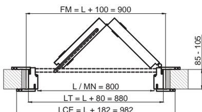
PORTA ROTOTRASLANTE TELAIO PKROTO / L8
