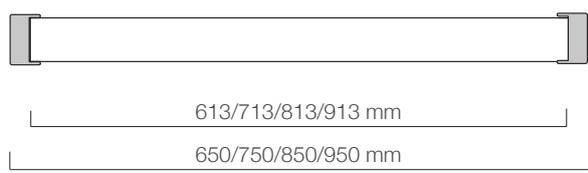
I n° 2 profili allargatori con adesivo già predisposto, sono da installare sui lati verticali dell'anta, consentendo di ottenere la larghezza desiderata maggiorata di 50 mm, al fine di coprire i vani muro finiti, intonacati, standard.
